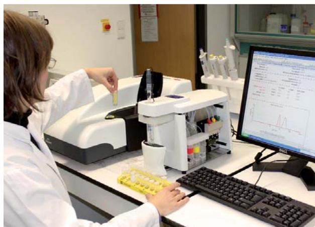
Abbildung 3: Messgerät für Partikelgrößenverteilungen
