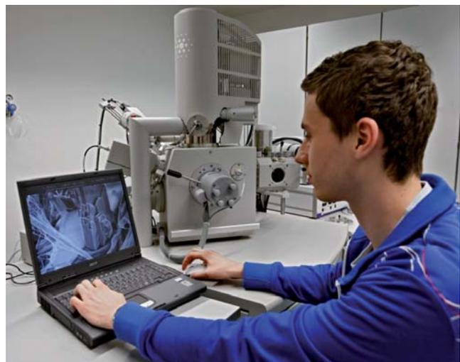
Abbildung 8: Rasterelektronenmikroskop als Imaging-System
