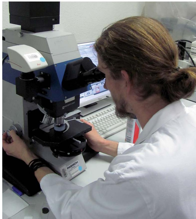
Abbildung 17: Lichtmikroskopie an einem Faserverbundwerkstück
