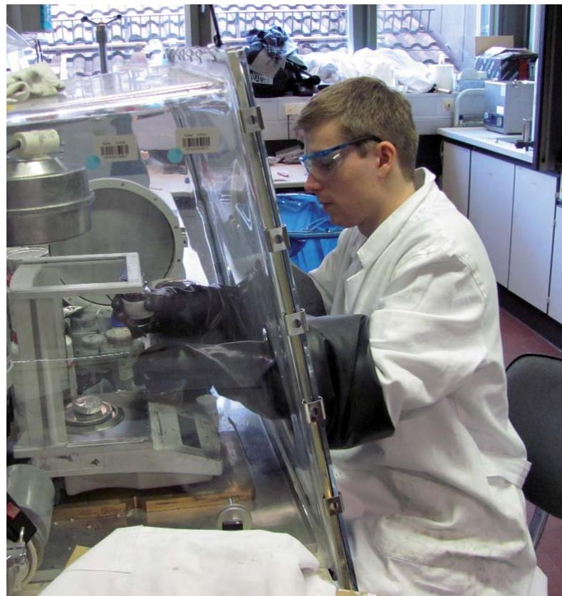
Abbildung 20: Dosieren von feinen Stäuben und Nanopartikeln in der Glovebox.
